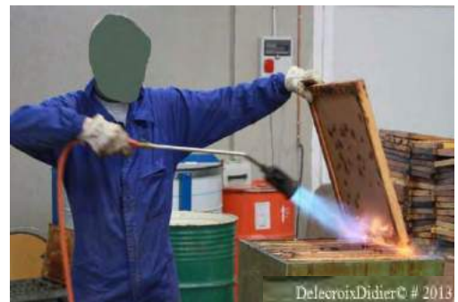
Pour travailler vite et bien, choisissez « un chalumeau puissant, installé sur une bouteille de 13kg de butane mais de préférence de propane si vous travaillez en extérieur ». Photo : Delecroix. Source : www.apiservices.com/rfa/articles/chalumeau.htm
