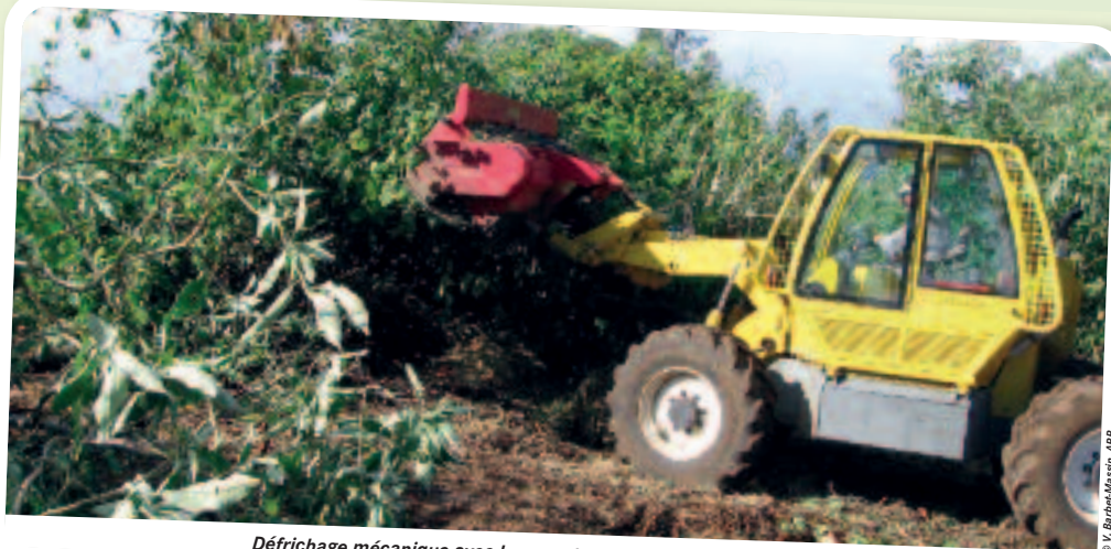
Défrichage mécanique avec broyeur type « forestier » porté sur bras
